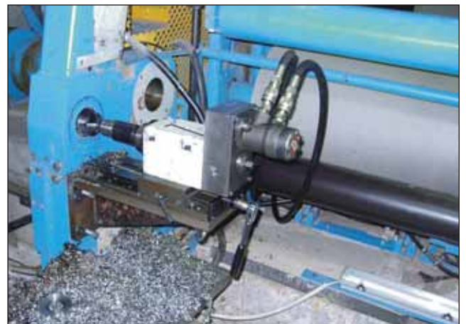
Längsbohrung in 120 mm starkes Vollmaterial Bohren und Aufspindeln Durchmesser 180 mm
