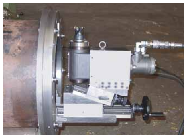
Fräsen einer axialen Nut in einen Rohrstutzen
