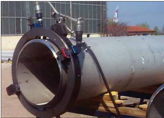
Herstellung von V-Nähten, J-Nähten und anderen Profilen ist möglich
