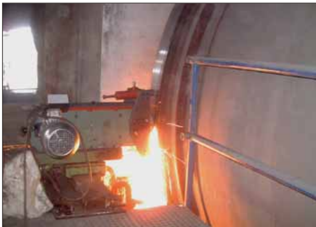
Mobile Schleifeinheit zur Bearbeitung von Laufringen
