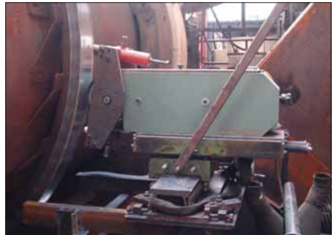
Mobile Schleifeinheit mit Schleifdruckregulierung über Federkräfte und eine "Dreipunkt"Anlage
