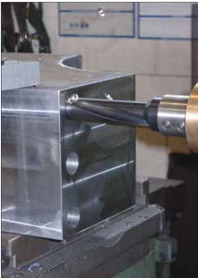
Längsbohrung im Durchmesserbereich vom 25 mm
