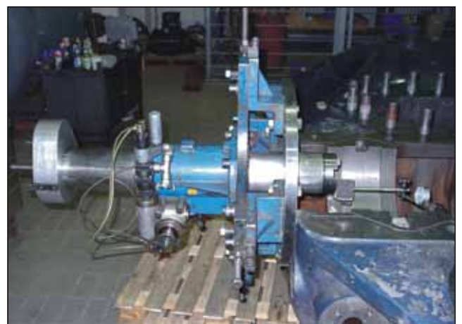
Bearbeitung von Lagersitzen an einer Turbine
