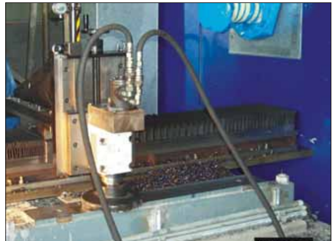
Fräsen von Maschinenfundamentplatten
