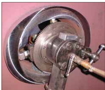
Fräsen und Schleifen von ovalen Mannlochdichtflächen
