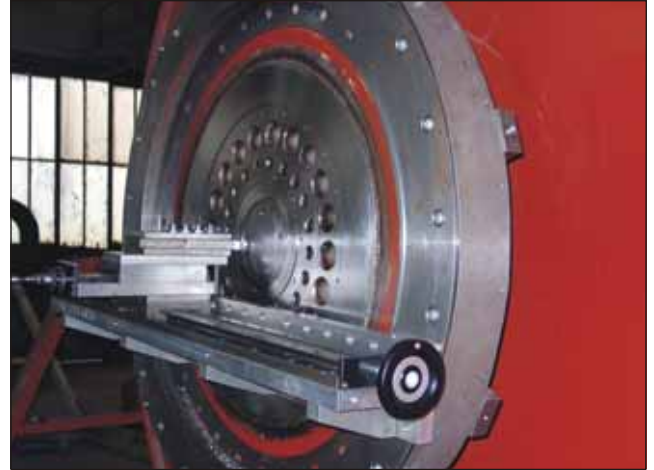
Combinaison spéciale d'une machine de tournage portable par prise extérieure et d'une table de fraisage pour un usinage spécifique
