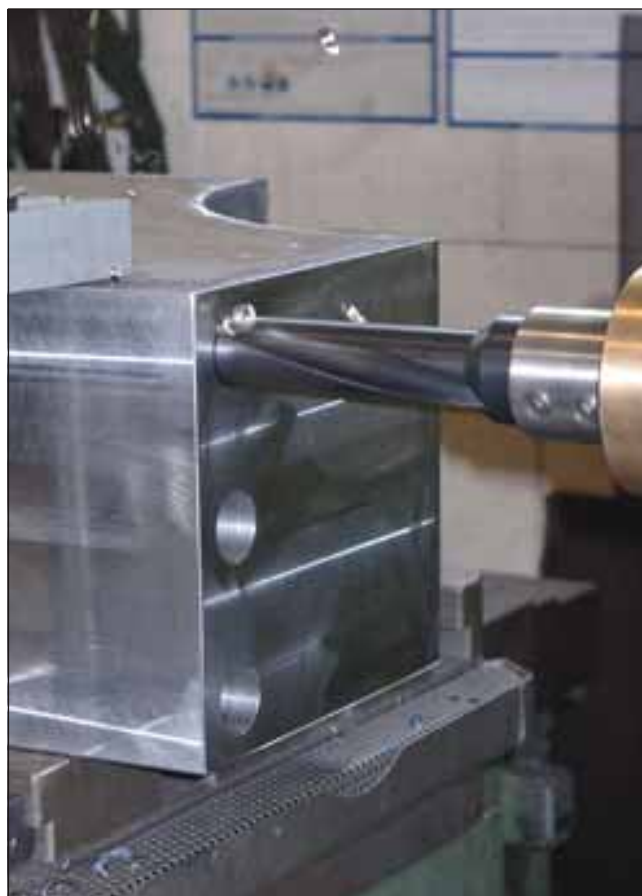
Perçage profond d'un diamètre de 25 mm
