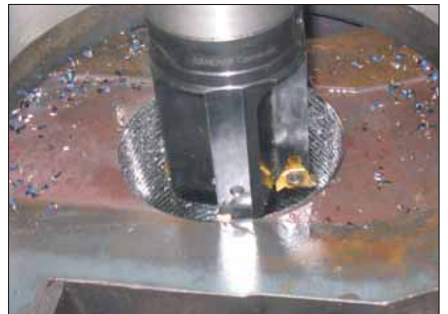
Fraisage d'un filetage intérieur sur une turbine par interpolation hélicoïdale avec une machine à commande numérique portable.
