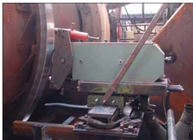
Ensemble de rectification portable monté sur ressort et butée de réglage de pression
