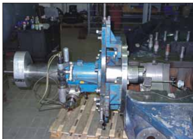
Reprise d'une portée de roulement sur une turbine
