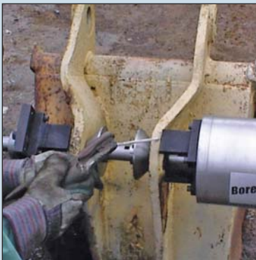
Schritt 2: Die Lagerschilde fixieren
