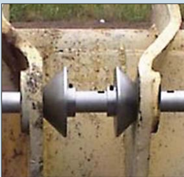
Schritt 1: Die Bohrstange zentrieren
